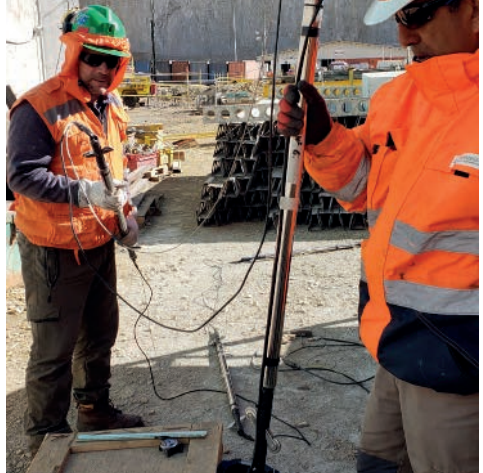
Instalación de inclino-extensómetro DEX-S, Mina Chuquicamata - Chile
