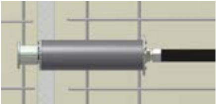
Esquema de instalación de deformímetro embebido
